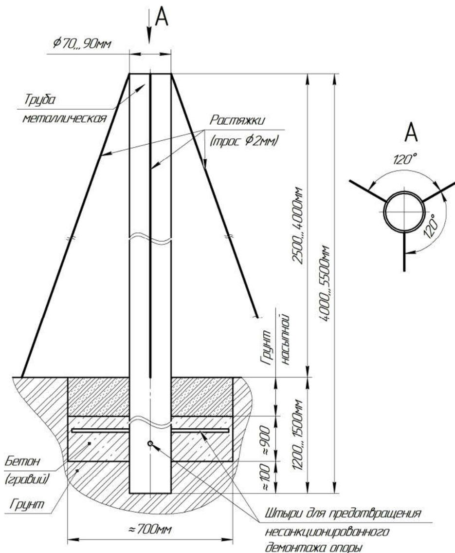
Рисунок 2.2 – Установка опоры высотой до 4 м
