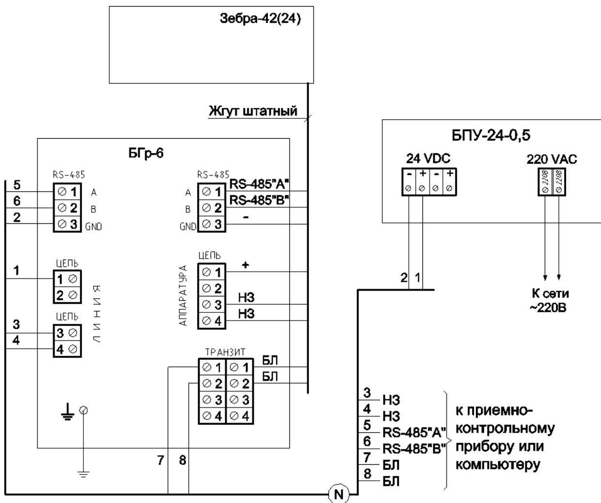
Рисунок – 2.9 Схема подключения извещателя при использовании блока грозозащиты «БГр-6».
