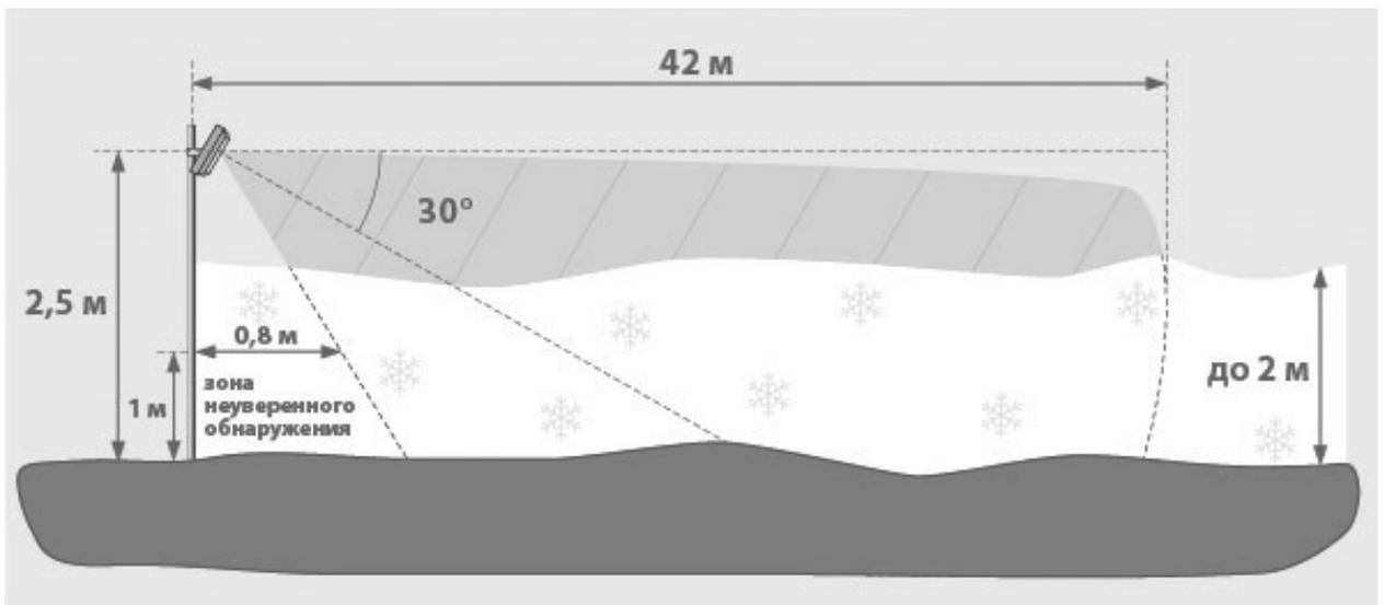
Рисунок 2.4 – Установка извещателя на высокой опоре в местах с высотой снежного покрова до 2 м
