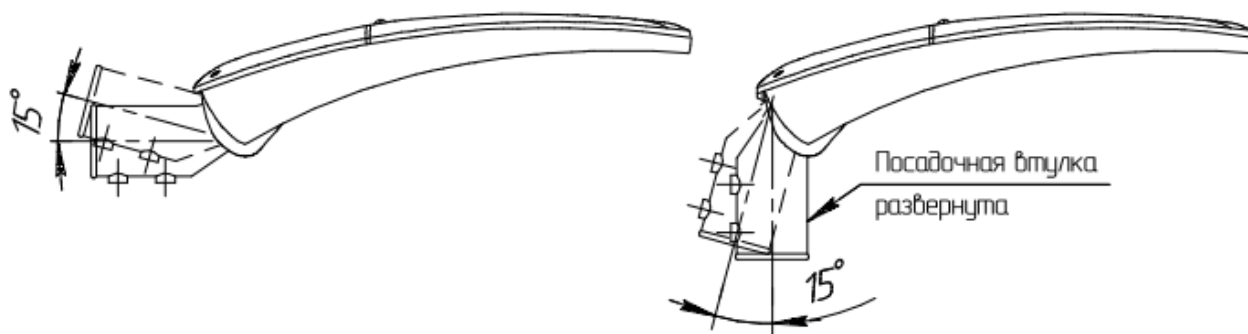
Рисунок 8.1 – Углы наклона светильника
