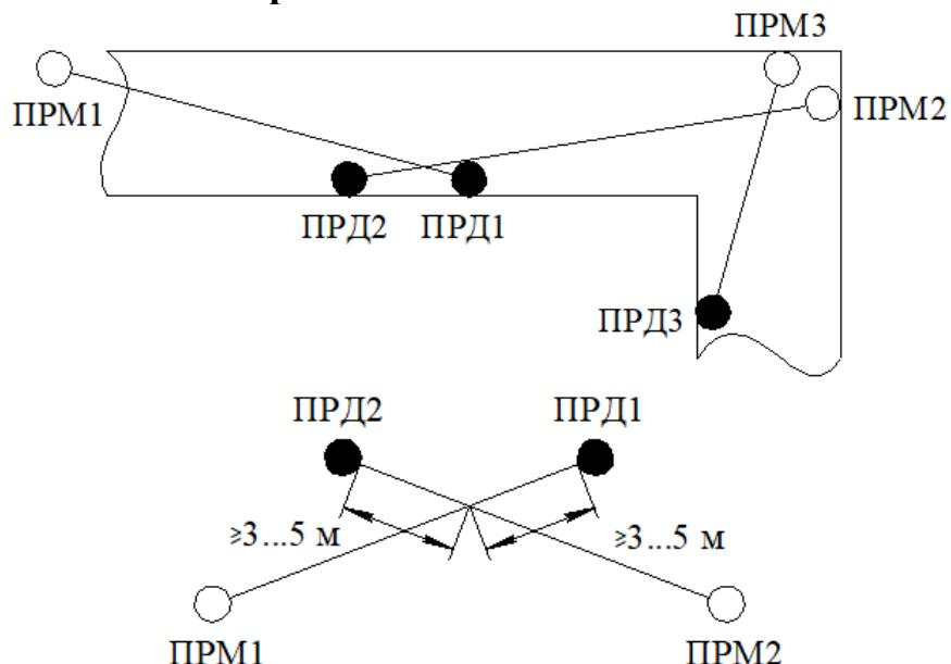
Рисунок 2.1 – Примеры разметки períметра для установки извещателей
