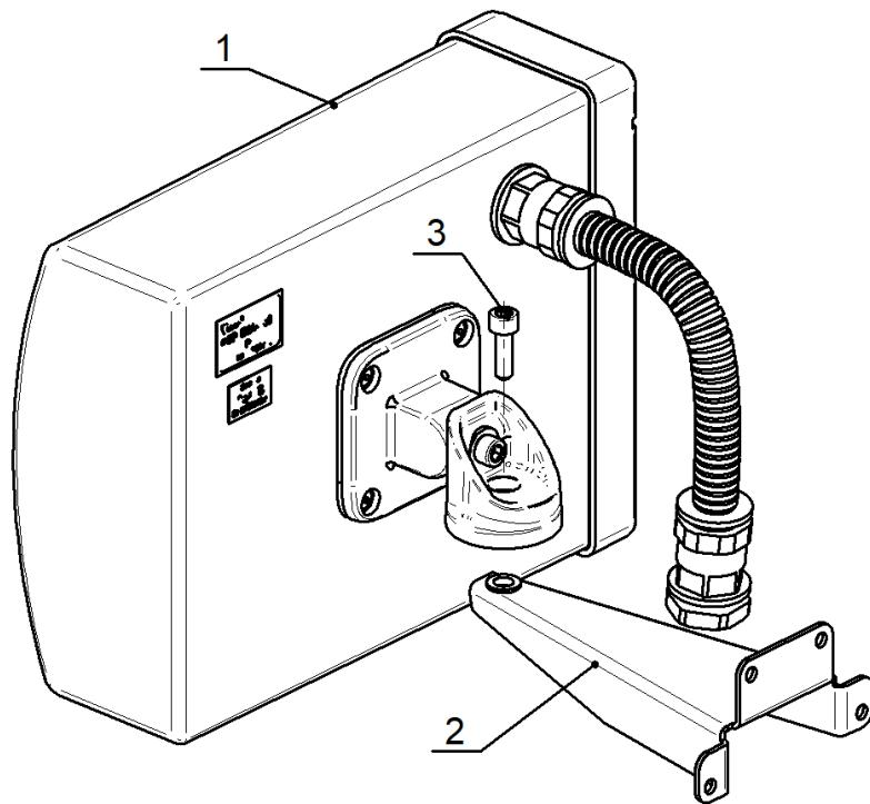
1 – блок ПРД (блок ПРМ); 2 – КРОНШТЕЙН-120М; 3 – винт М5
