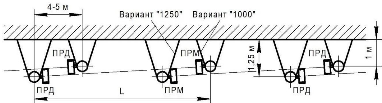
Рисунок 2.6 – Пример установки извещателей «ФОРТЕЗА-М» (исполнение «А») на «Кронштейн-1000/1250» с перекрытием зон обнаружения
