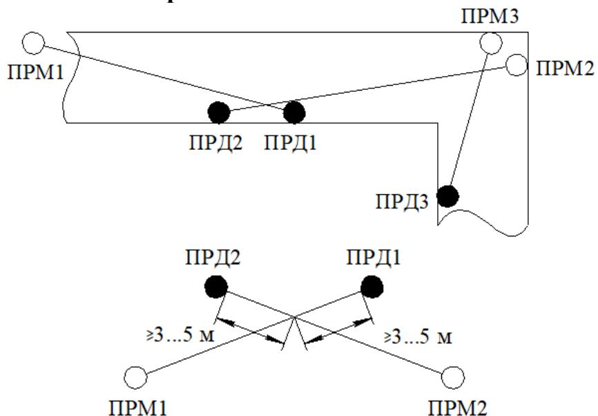
Рисунок 2.1 – Примеры разметки периметра для установки извещателей
