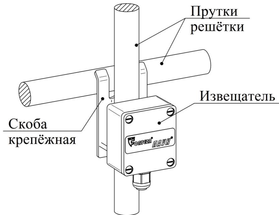
Рисунок 2.1 – Крепление извещателя на решётке из прутка
