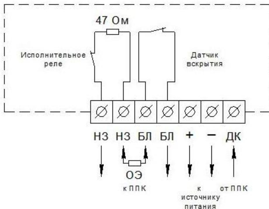
Рисунок 2.5 – Колодка извещателя для внешних подключений
