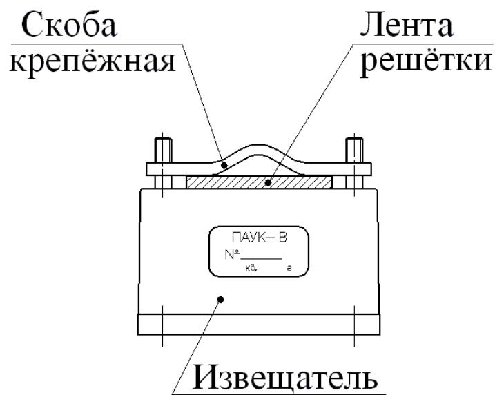
Рисунок 2.2 – Крепление извещателя на решётке из металлических лент
