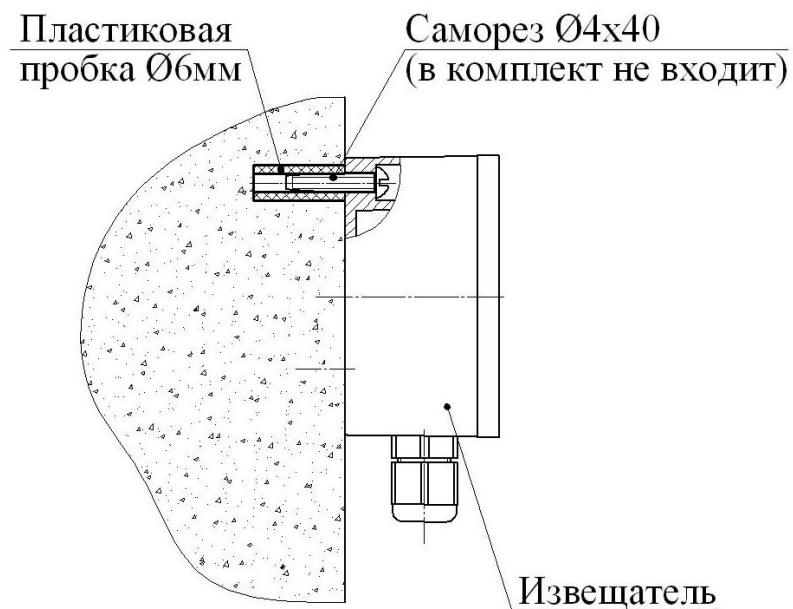
Рисунок 2.7 – Крепление извещателя
