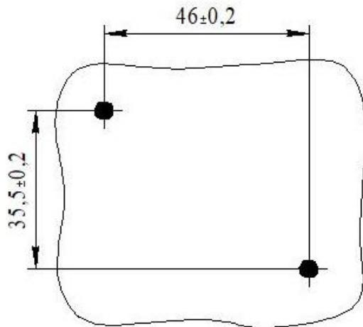
Рисунок 2.3 – Разметка для сверления отверстий
