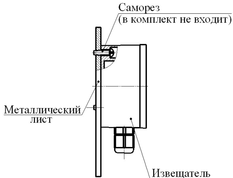
Рисунок 2.4 – Крепление извещателя на металлическом листе
