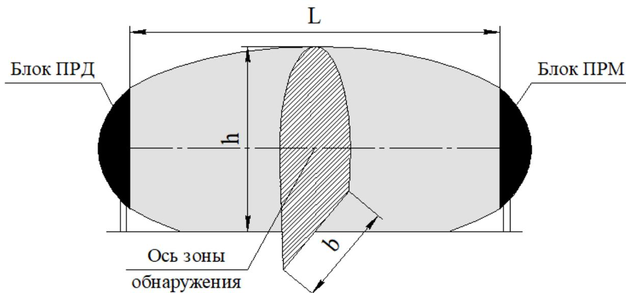
Рисунок 1.2 – Конфигурация зоны обнаружения, формируемой извещателями «ФОРТЕЗА-300А», «ФОРТЕЗА-500А»
