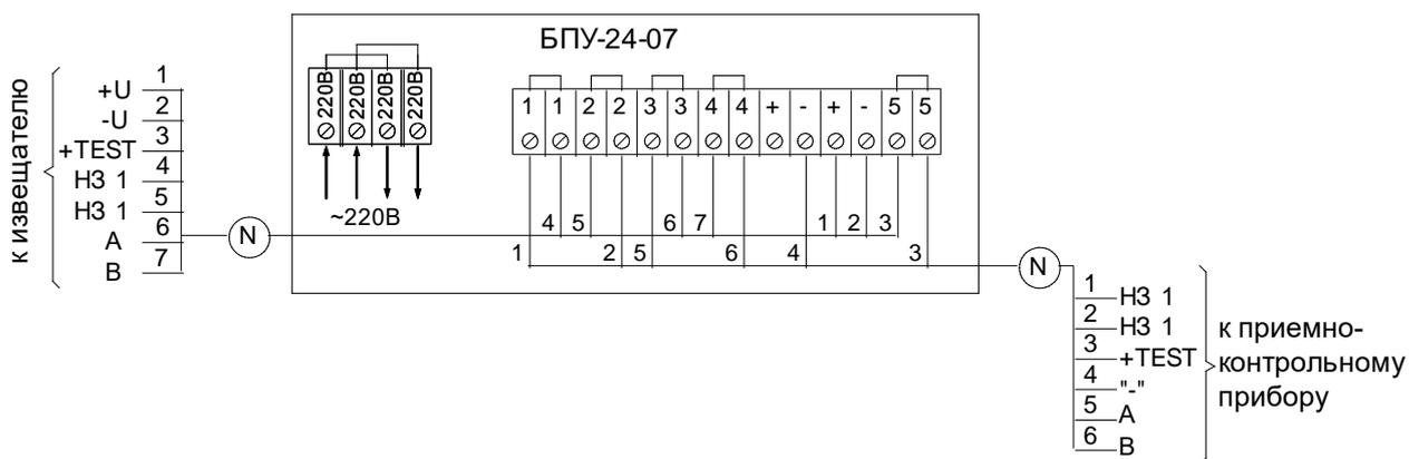
Рисунок 2.11 – Схема подключения извещателя к блоку питания «БПУ-24-0,7»
