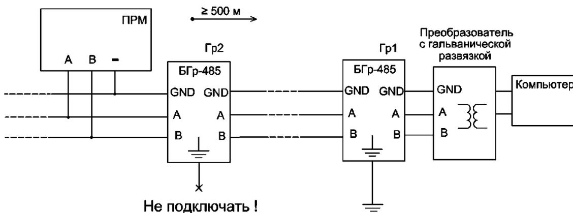
Рисунок 2.13 – Пример обеспечения грозозащиты линии RS-485
