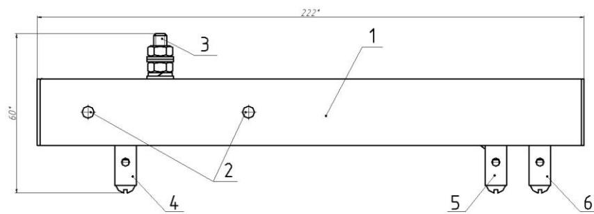
1 – корпус; 2 – отверстия крепления блока к кронштейну; 3 – болт заземления;
