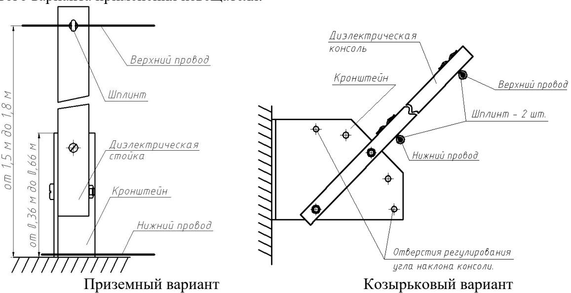
Рисунок 2.5 – Крепление проводов линейной части извещателя
