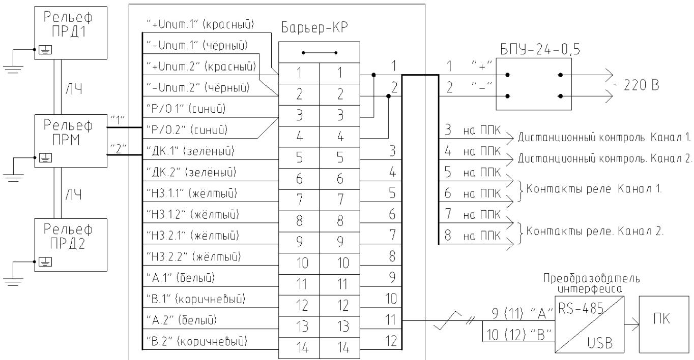
Рисунок 2.8 – Подключение извещателя к коробке распределительной (индикатор включен).
