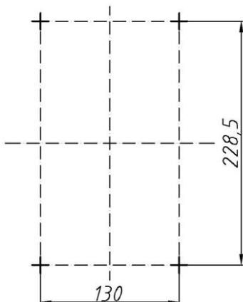
Рисунок 2.7 – Разметка для крепления блока ПРМ.
