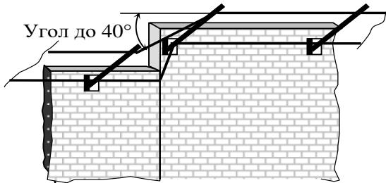
Рисунок 2.3 – Крепление КМЧ и проводов при перепадах высоты
