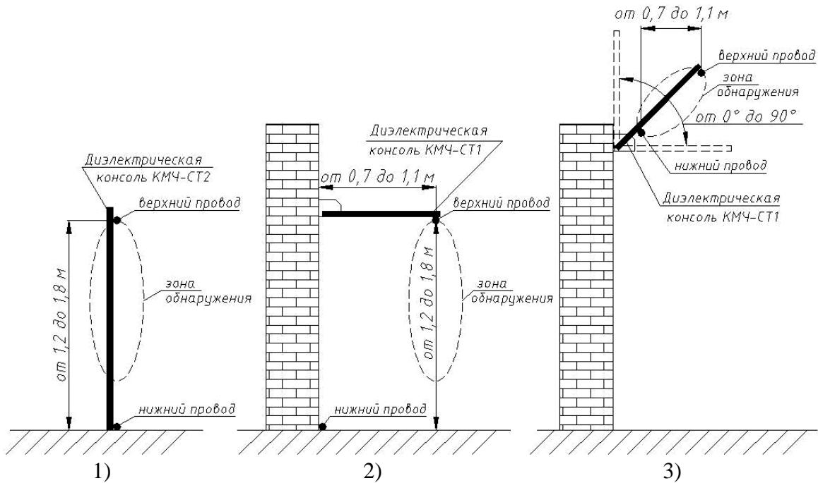
Рисунок 2.1 – Варианты размещения линейной части извещателя
