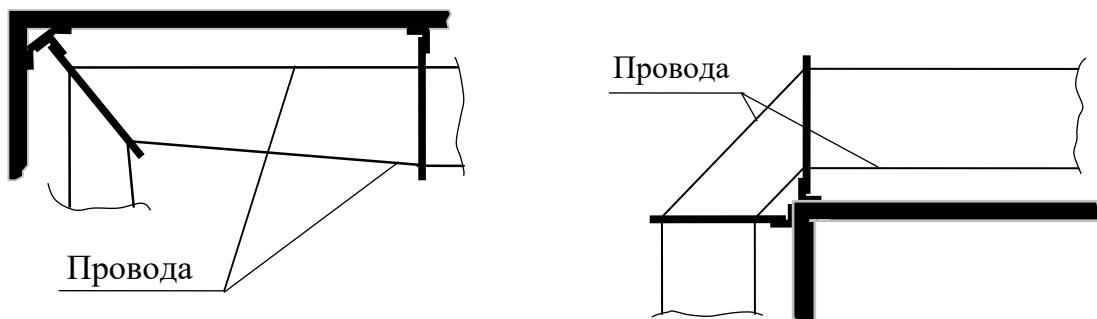
Рисунок 2.2 – Крепление КМЧ и проводов при поворотах на внутренних и внешних углах.
