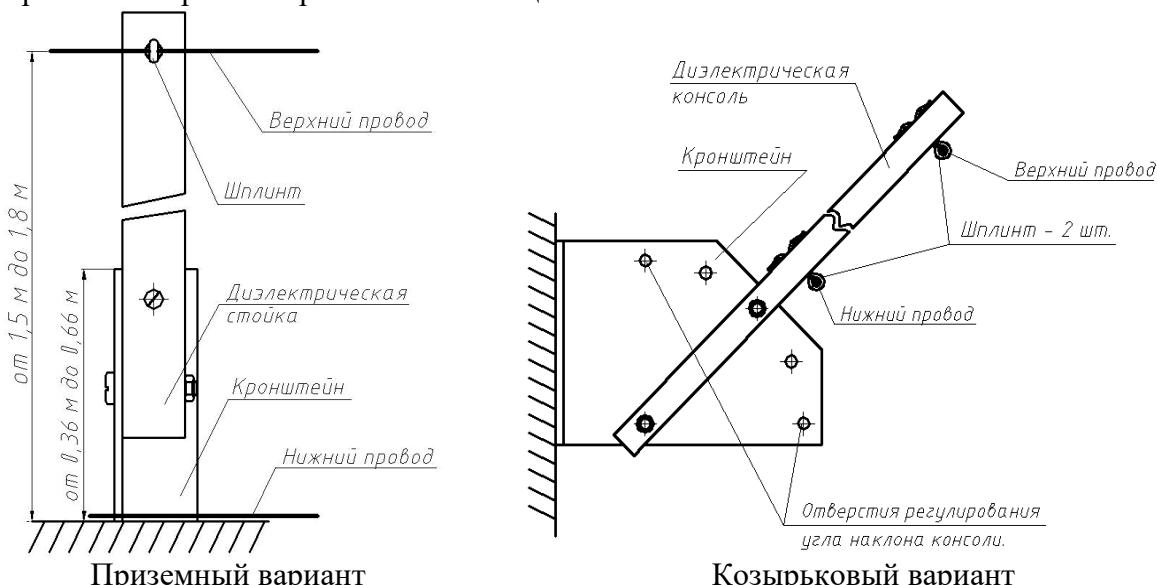
Рисунок 2.5 – Крепление проводов линейной части извещателя
