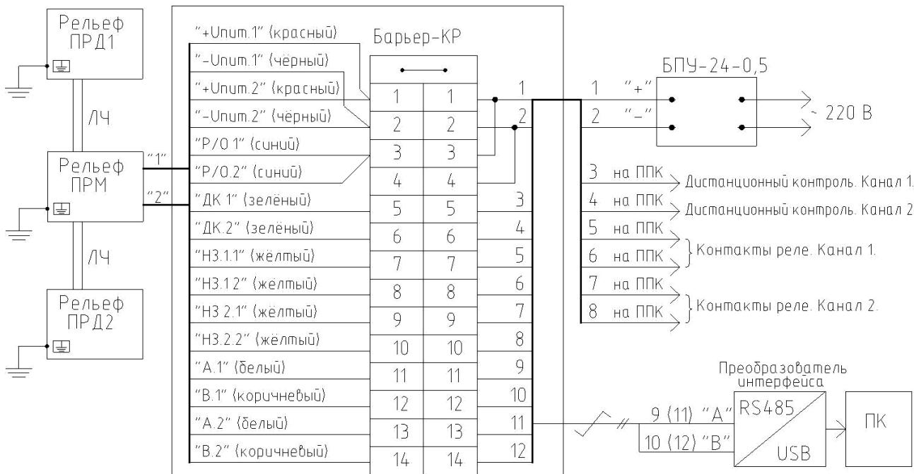
Рисунок 2.8 – Подключение извещателя к коробке распределительной
