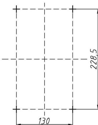
Рисунок 2.7 – Разметка для крепления блока ПРМ.
