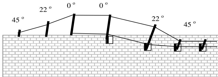
Рисунок 2.4 – Переходы линейной части
