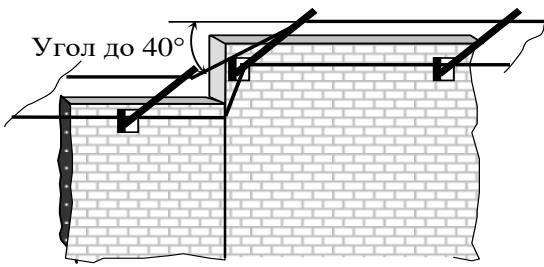
Рисунок 2.3 – Крепление КМЧ и проводов при перепадах высоты
