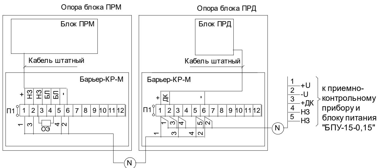
**Подключение извещателя транзитом через блок ПРМ**
