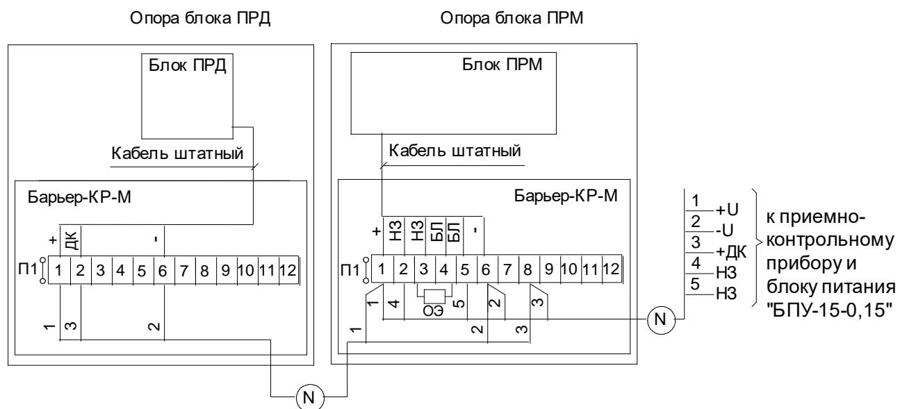
**Рисунок 2.8 – Схема подключения извещателя при использовании распределительной коробки «БАРЬЕР-КР-М».**
