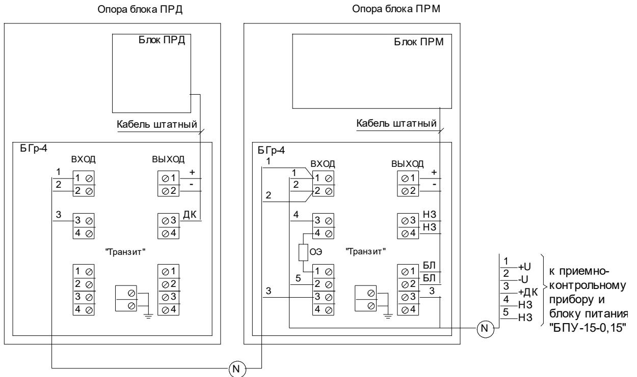
Рисунок 2.9 – Схема подключения извещателя при использовании внешнего блока грозозащиты «БГр-4».
