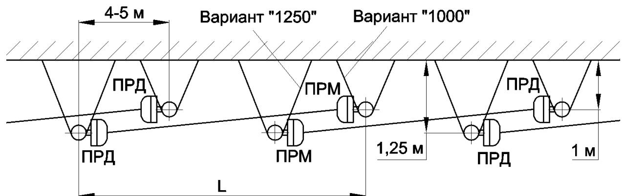
Рисунок 2.4 – Пример установки извещателей «FMW-3T», «FMW-3/1T», «FMW-3/2T» на «Кронштейне-1000/1250» с перекрытием зон обнаружения
