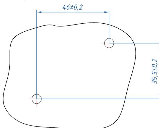
Рисунок 3.3 – Разметка для сверления отверстий
