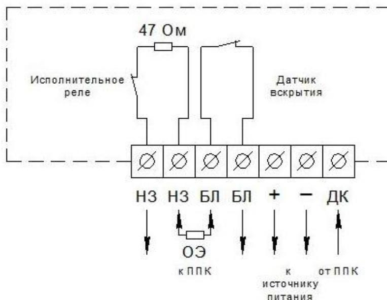
Рисунок 3.6 – Колодка извещателя для внешних подключений
