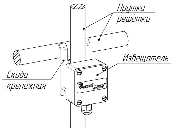
Рисунок 3.1 – Крепление извещателя на решетке из прутка
