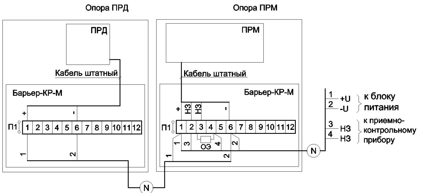
ОЭ – оконечный элемент приемно-контрольного прибора.
