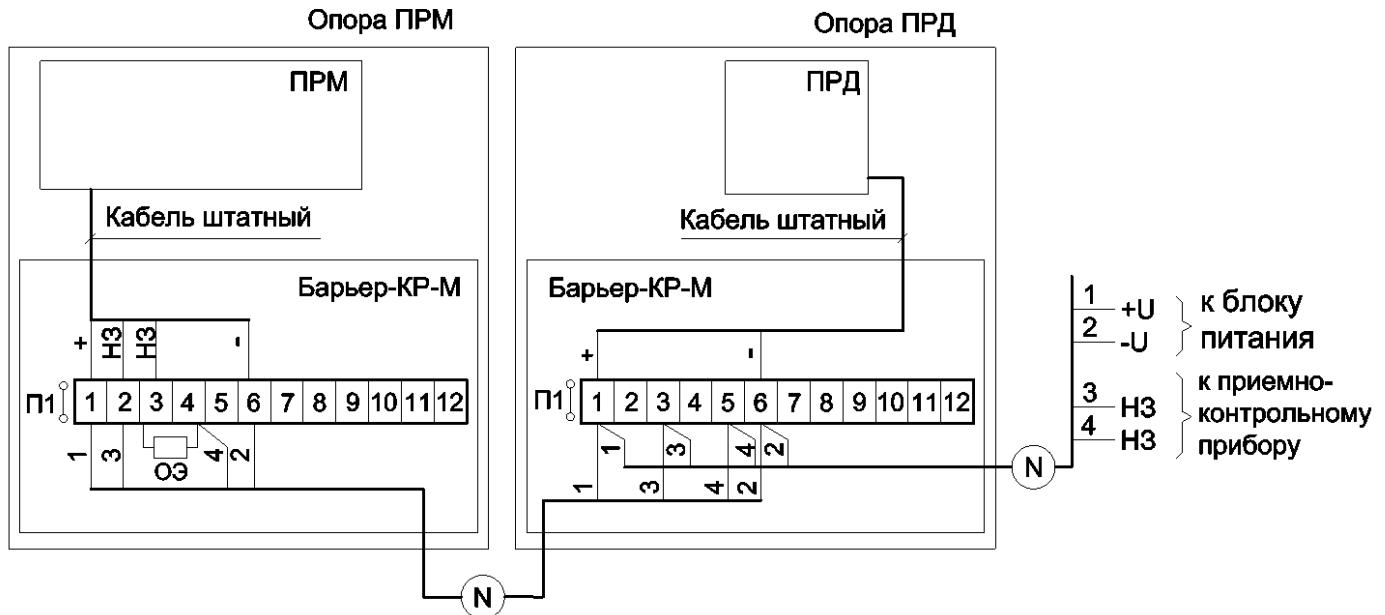
Подключение извещателя транзитом через приемник
