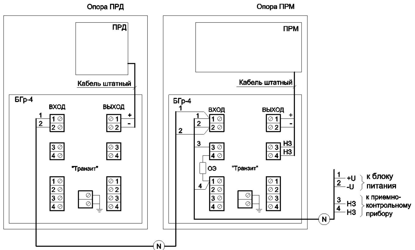
ОЭ – оконечный элемент приемно-контрольного прибора.
