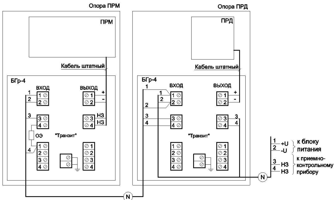
Подключение извещателя транзитом через приемник (через БГр-4)
