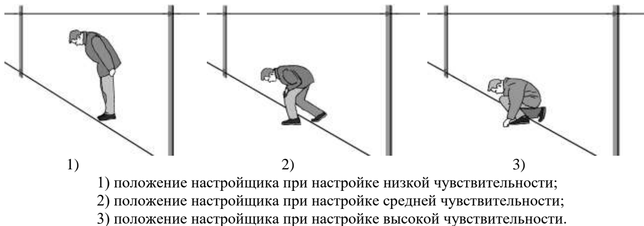
Рисунок 2.11 Способы имитаций преодоления 30 при приземном варианте установки.
